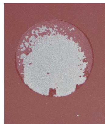
Použijeme-li na očištění odmašťovač, nelze barvu od povrchu odtrhnout ani při extrémních silách. Barva se díky dokonalé přilnavosti nikdy neoloupe. V části plochy je přídržnost barvy dokonce vyšší než přilnavost lepidla.
