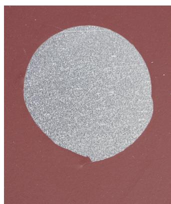
Po odmaštění povrchu saponátem vykazuje barva standardní přilnavost. Spojení barvy s povrchem však není dokonalé.
